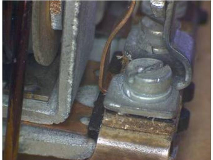
Lame-axe virtuel de la palette de régulation, on devine la seconde moitié lames-axe virtuel de la bobine de conjoncteur
