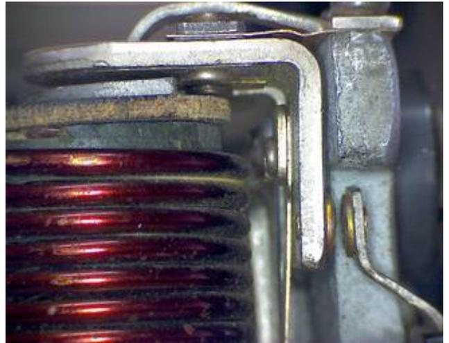
Contacts du régulateur. Le fil cuivre de limitation de courant est de section rectangulaire.
