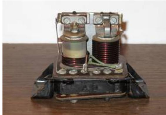
C'est un régulateur à deux bobines, l'une sert à régler la tension (voltage) à gauche de la photo, l'autre à la jonction (Cut-Out ou conjoncteur-disjoncteur), à droite de la photo.
