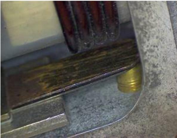
Lame-ressort et bilame, réglage de régulation
