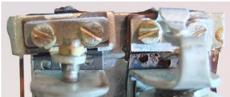
Lame-ressort d'axe virtuel corrodée (à droite)
