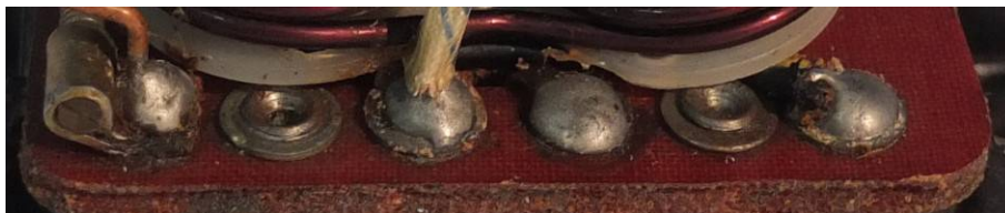
Résidus de flux corrosif sur les brasures de sortie
