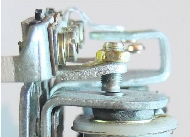
Contact de la bobine de tension, écrou bloqué et collé
