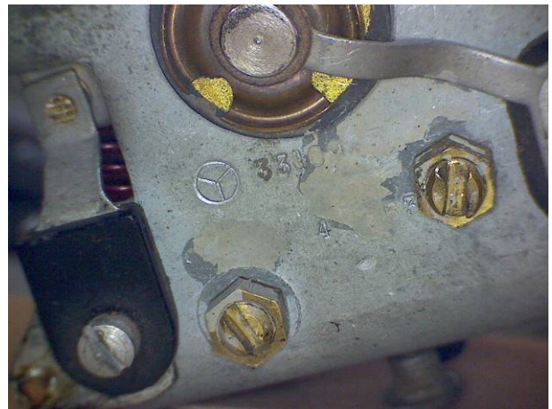
Les vis de réglage et contre-écrous de tension des ressorts. La résistance pastille montre sa surface dorée de contact, dans les trous du ressort d'appui.
