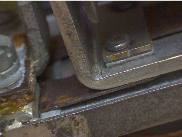
Lame-axe virtuel de la palette de régulation, on devine la seconde moitié de la lame
