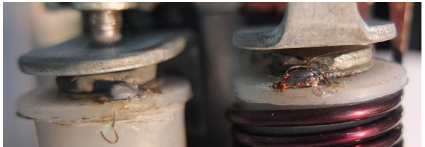
Résidus de flux corrosif sur les fils fins
