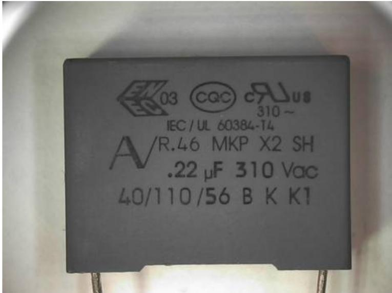
Électrodes de sortie diamètre 0,56 mm
