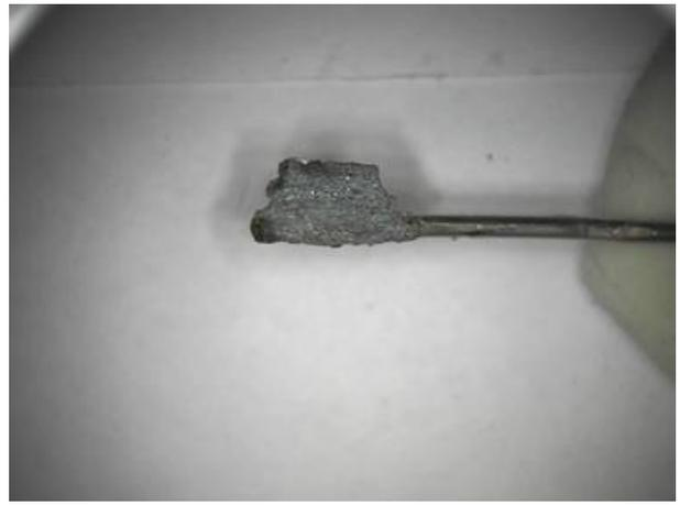
le schoopage, épais, 0,7 mm, ne tient pas sur l'extrémité des spires d'aluminium (cas d'espèce ou erreur du process?) maintenu par la mince couche d'époxy et le boîtier thermoplastique.
