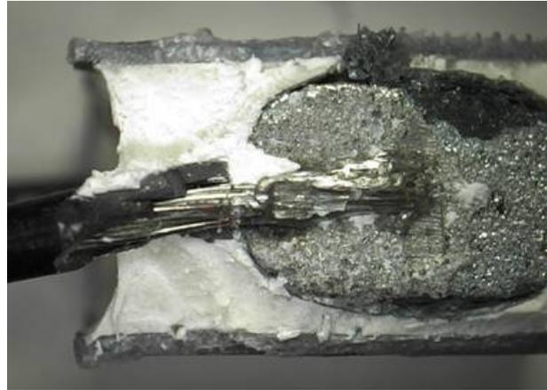
c'est le frère du petit gris, avec une construction interne différente et une douille sertie pour bornier. **longueur de brasure sur le schoopage 5 mm (contre 6,5 mm pour le petit gris ordinaire)**, c'est le fil multibrins qui est directement brasé sur le schoopage.
