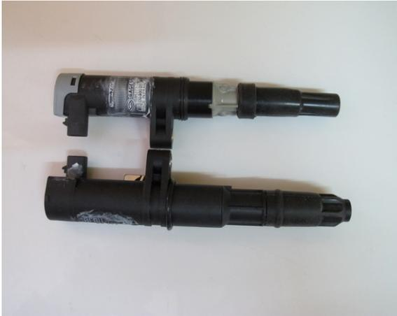
bobine Sagem et Beru la différence de longueur du plan de pose à l'extrémité de bougie est compensée par le ressort interne de contact THT
