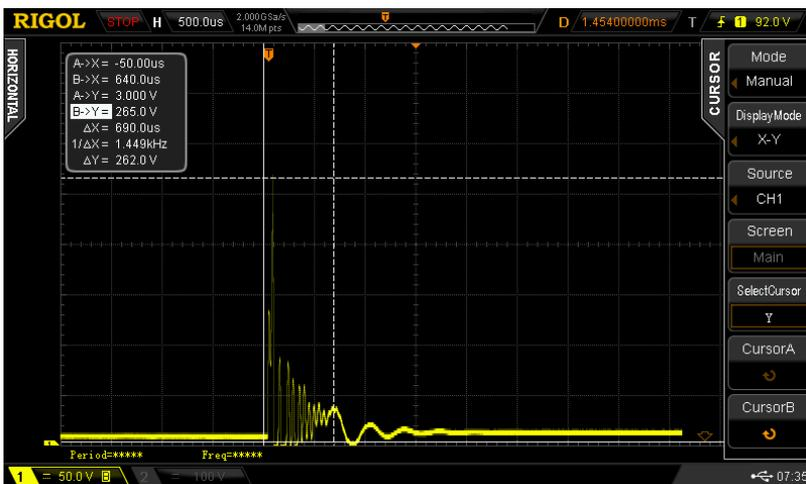
tension aux bornes de la capa éclateur 8mm
