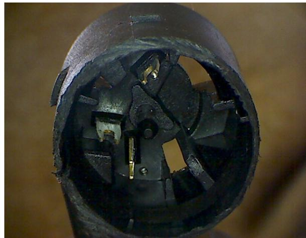
Chapeau de contact : il relie la bobine au connecteur externe. Les doigts s'insèrent dans les clips photo de gauche. Il y a 3 doigts pour 2 broches, deux broches sont reliées dans ce chapeau
