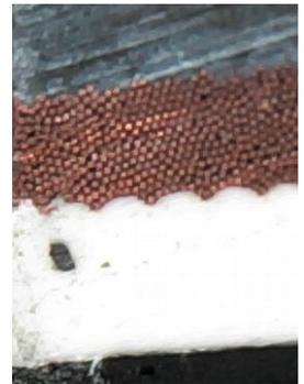
Beru utiliserait donc du téflon et de l'émail renforcé, de performances supérieures aux matériaux Sagem et les process apparemment mieux maîtrisés, permettent un meilleur remplissage des vides par l'époxy.
