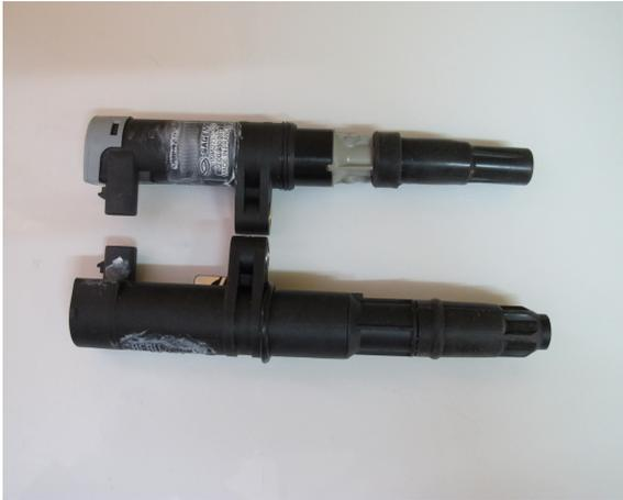
bobine Sagem et Beru la différence de longueur du plan de pose à l'extrémité de bougie est compensée par le ressort interne de contact THT
