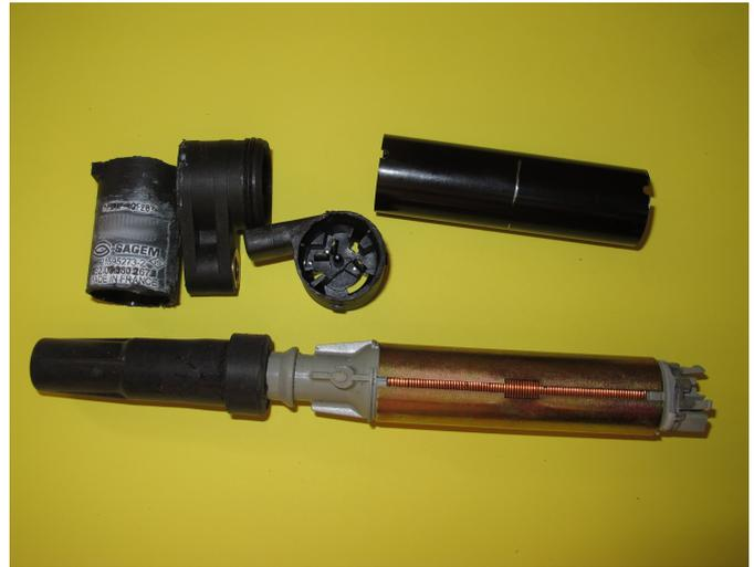
ouverture bobine Sagem en haut à droite ressort acier qui pince le cylindre de blindage magnétique (fer cadmié bichromaté jaune) on voit le bobinage primaire par la fente
