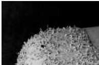
Whiskers sur l'électrode extérieure en étain pur d'un condensateur céramique de taille comparable au 0,22 \mu testé. Les électrodes internes heureusement ne sont pas en étain. Peu de métaux créent des whiskers dont étain, et cadmium, cliché NASA
