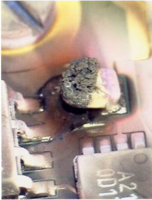
conséquences ultimes de fissures sur capas céramiques
