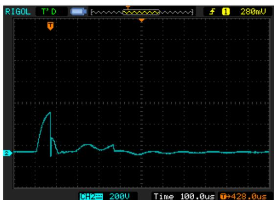
Avec une capa de 0,22µF en sortie du Boyer, il n'y a plus d'amorçage interne dans la bobine, et la tension primaire monte à des valeurs moindres. L'amorçage normal survient 70ns après la montée initiale.
