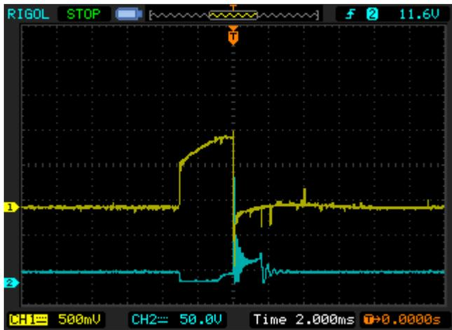
$I_{max}=3,9A$  temps de pulse 3ms, début de désaturation du BU2508
