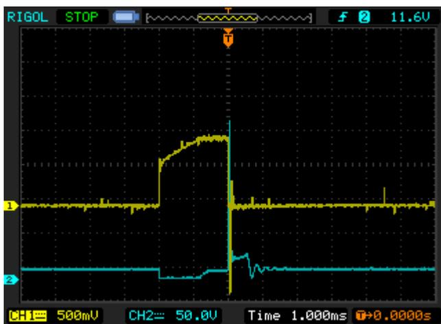
$I_{max} = 4\text{A}$ , le transistor commence à désaturer à 1,2ms
