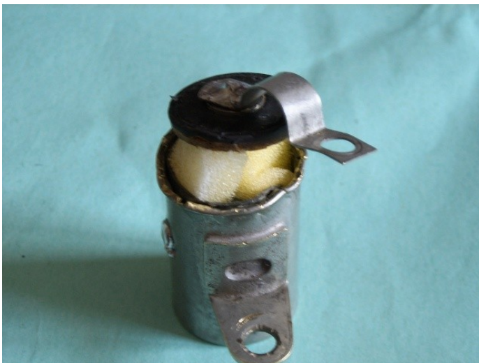
Source Bernique : une capa film montée avec de la mousse, sans epoxy
