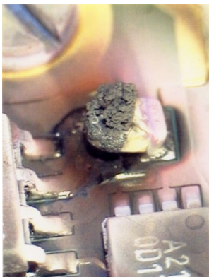
conséquences ultimes de fissures sur capas céramiques pourtant utilisées avec une marge de tension correcte
