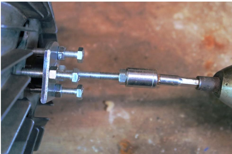
Un couplage à pseudo-cardan a finalement été utilisé avec écrou et contre-écrou entraînés par une douille, séparant mieux la perceuse du volant.
