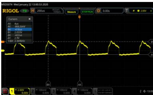
bobine FAGY + 0,22µF f = 2,37 \text{ kHz} Vc = 3V
